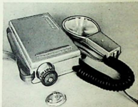
Bild 3. Die Batteriezellen lassen sich leicht durch eine runde Öffnung auswechseln
